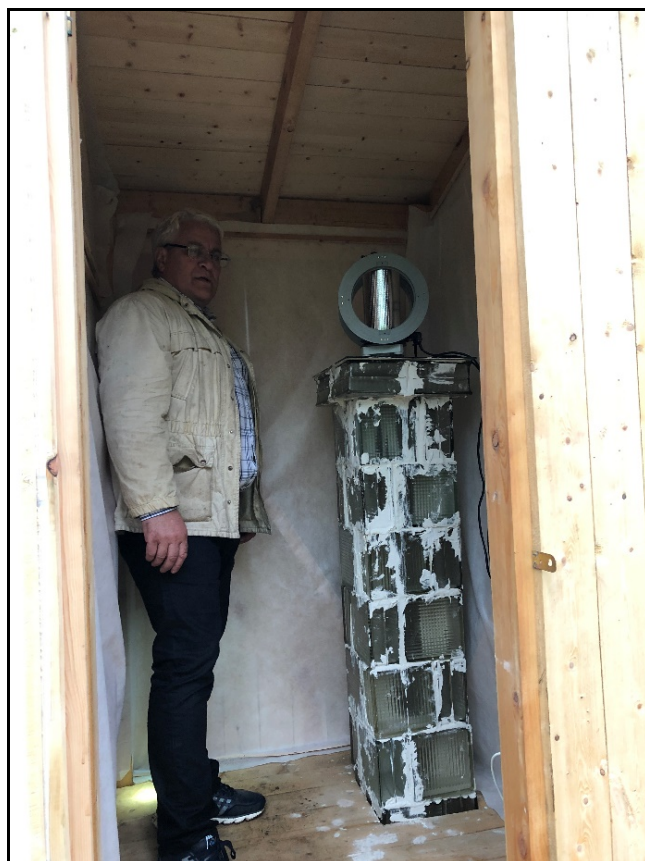
Член Секции геомагнетизма и аэрономии д.ф.-м.н. А.В. Хохлов возле установленного магнитометра экспериментальной конструкции POS-4, установленного в специально построенном немагнитном павильоне на территории Беломорской биологической станции им. Н.А. Перцова Биологического факультета МГУ им. М.В. Ломоносова
