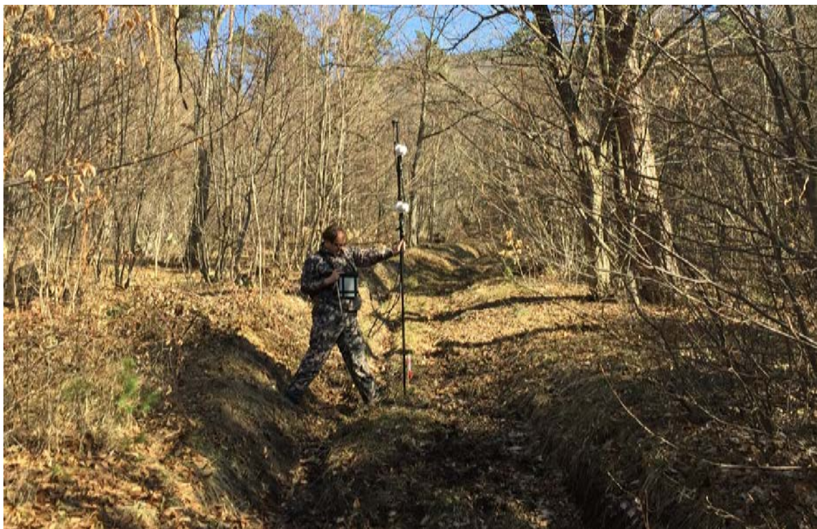
Магнитоградиентометрическая съемка на территории геофизического полигона ИГИС НАН РА.
